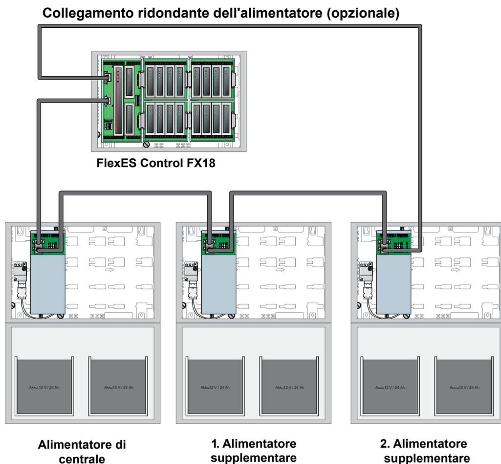
Schema di connessione con alimentatori connessi ad anello
