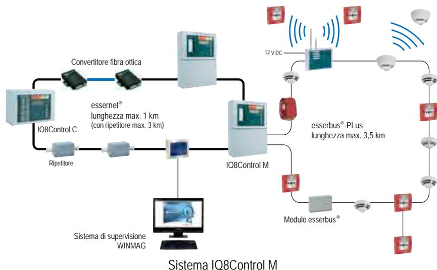
**Struttura e schema di composizione IQ8Control M**
