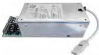
Alimentatore aggiuntivo per centrali rivelazione incendio FlexES. Ogni centrale può essere dotata di tre moduli di alimentazione. Ogni alimentatore deve essere alloggiato in un armadio separato. Un modulo di alimentazione può supportare fino ad un massimo di 4 batterie da 12 V / 24 Ah (pari a 24 V / 48 Ah).
