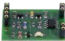
Scheda elettronica di gestione del corto circuito su loop da inserire nei moduli di interfaccia esserbus® privi dell'isolatore integrato. Isola eventuali corto circuiti sul loop evitando il malfunzionamento dell'intero sistema.
