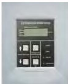
Pannello di visualizzazione in plastica per centrali FlexES Control. Montaggio a parete. La connessione avviene mediante interfaccia seriale della centrale rivelazione incendio. Display composta da 4 righe per 20 caratteri ciascuno, su cui possono essere visualizzati contemporaneamente 2 messaggi. E' possibile programmare fino a 4000 testi. Mediante l'interfaccia ADP-N3E-U-EDP (cod. FX808381) è possibile collegare fino a 16 Pannelli di visualizzazione LCD in modalità ridondante.
