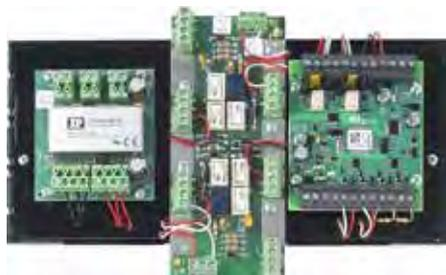
Il modulo permette di gestire la ridondanza della rete essernet® per le centrali serie FlexES Control. Assicura la continuità e la funzionalità in caso di disturbi o interruzioni della rete essernet®. Il modulo viene alimentato dalla centrale di rivelazione incendio. Distanza massima tra ogni modulo: 1.000 m. Convertitore di tensione e modulo di interfaccia esserbus® integrati.
