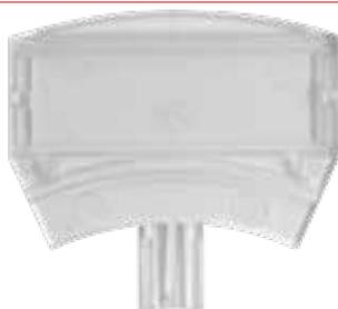
Placca di identificazione da inserire nella parte laterale del rivelatore su cui applicare etichette per identificare il loop, la zona e l'indirizzo del rivelatore. Dimensione massima dell'etichetta adesiva applicabile: 58 x 18 mm. Ottimizzata per una visibilità fino a 3 m di altezza.
