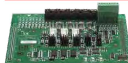
**Modulo di espansione con 3 o 4 uscite relè e trasmissione allarmi**
