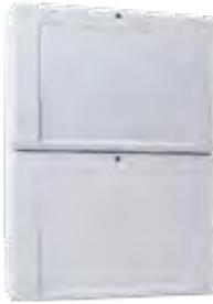
Alimentatore supplementare per l'espansione dell'alimentazione interna del sistema. L'alimentatore supplementare integra l'alimentatore di centrale con ulteriori 150 W, mediante un collegamento via cavo ad anello. L'armadio può contenere fino a due batterie supplementari da 12 V/24 Ah. Due batterie ulteriori da 24 Ah possono essere collegate utilizzando l'armadio supplementare codice FX808313. Componenti aggiuntivi possono essere montati sulle guide DIN presenti nel box.
