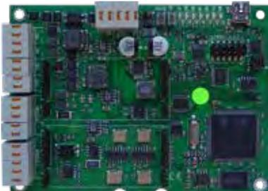
Modulo adattatore per il collegamento del web server ERA FX808080 ad una centrale FlexES Control.
