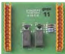
Scheda a relè per alimentatore esterno 2401 per la trasmissione dei messaggi "guasto di rete" e "guasto batteria" alla centrale rivelazione incendio.
