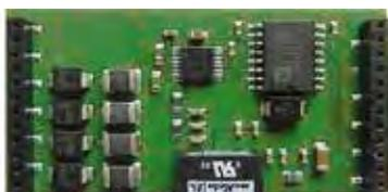
Modulo con protocollo RS232 per Interfaccia seriale essernet® bidirezionale SEI2. Include separatore galvanico.
