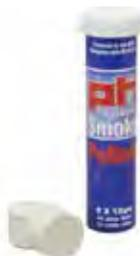
Cartuccia in grado di generare fumo denso e bianco. Utilizzabile per valutare l'efficienza dei sistemi di aspirazione ed il flusso d'aria. La cartuccia viene accesa mediante fiammifero o accendino e si spegne automaticamente all'esaurimento del combustibile. Appoggiare la cartuccia su una base non infiammabile. Dopo l'accensione la cartuccia si riduce in cenere senza formazione di fiamme.
