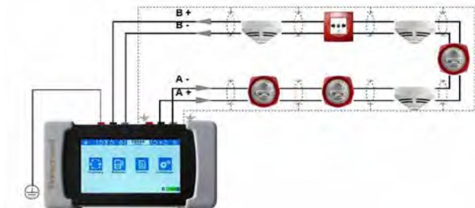
Esempio di connessione per identificare la topologia Loop
