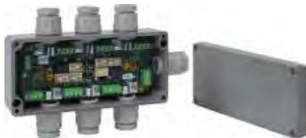
Il modulo permette di gestire la ridondanza della rete essernet® per le centrali serie IQ8Control. Assicura la continuità e la funzionalità in caso di disturbi o interruzioni della rete essernet®. Il modulo viene alimentato dalla centrale di rivelazione incendio. Distanza massima tra ogni modulo: 1.000 m.
