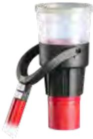
Dispositivo di test per la verifica della funzionalità dei sensori puntiformi di fumo serie IQ8Quad e Serie 9x00. Emesso l'aerosol che simula il fumo, il rivelatore entra nello stato di allarme e il corretto funzionamento viene verificato mediante l'attivazione dell'allarme in centrale. Il dispositivo può essere utilizzato con l'asta telescopica in plastica codice 060427.
