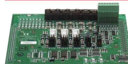
Modulo di centrale per trasmissione allarme e 3 relé
