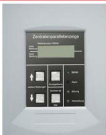
Pannello di visualizzazione in plastica per centrali FlexES Control. Montaggio a parete. La connessione avviene mediante interfaccia seriale della centrale rivelazione incendio. Display composta da 4 righe per 20 caratteri ciascuno, su cui possono essere visualizzati contemporaneamente 2 messaggi. E' possibile programmare fino a 4000 testi.
