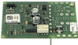
Modulo elettronico innestabile, con contatto di ingresso monitorato, per il controllo delle attivazioni di dispositivi antincendio (esempio serrande tagliafuoco).
