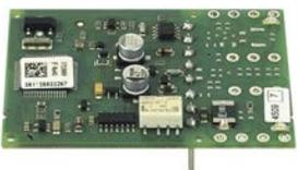
Modulo elettronico innestabile, con contatto di ingresso monitorato ed 1 uscita, per il controllo delle attivazioni di dispositivi antincendio (esempio serrande tagliafuoco).
