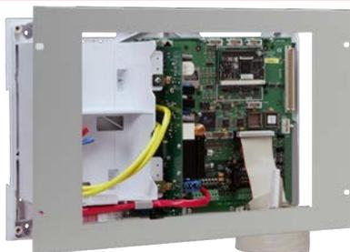
Configurazione di base in versione 19" (7 Unità) per installazione rack.
