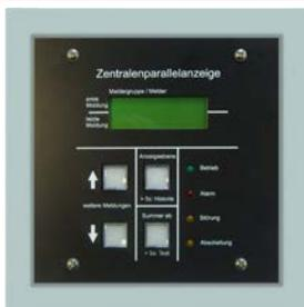
Pannello di visualizzazione in plastica per centrali FlexES Control. Montaggio ad incasso. La connessione avviene mediante interfaccia seriale della centrale rivelazione incendio. Display composta da 4 righe per 20 caratteri ciascuno, su cui possono essere visualizzati contemporaneamente 2 messaggi. E' possibile programmare fino a 4000 testi.
