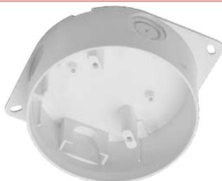
Base adattatrice a montaggio superficiale da utilizzare in ambienti con elevata presenza di polvere ed umidità. Utilizzabile con le basi per sistemi serie IQ8Quad e serie ES Detect. Dispone di tre fori per passacavi M20 (opzionali). Eleva il grado di protezione ad IP43.
