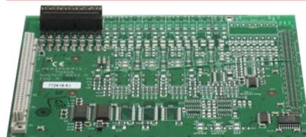
Modulo di espansione con uno slot per micromodulo
